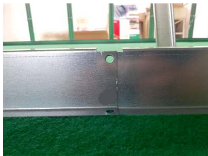
Spojení bočních základnen (poz. 1-01 a 1-02).
